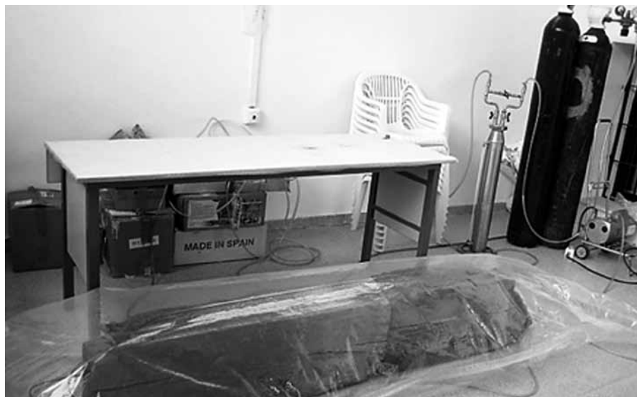
Lámina 7. Desinsectación con gases inertes.
