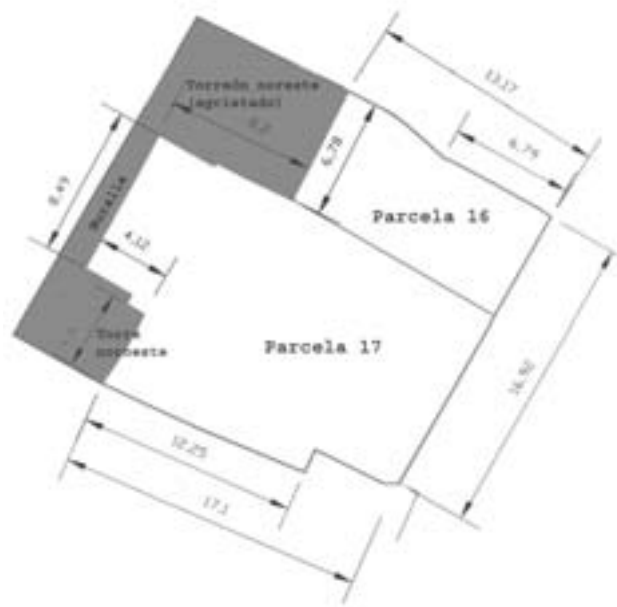
Figura 2. Situación de los torreones y la muralla con respecto a las parcelas.
