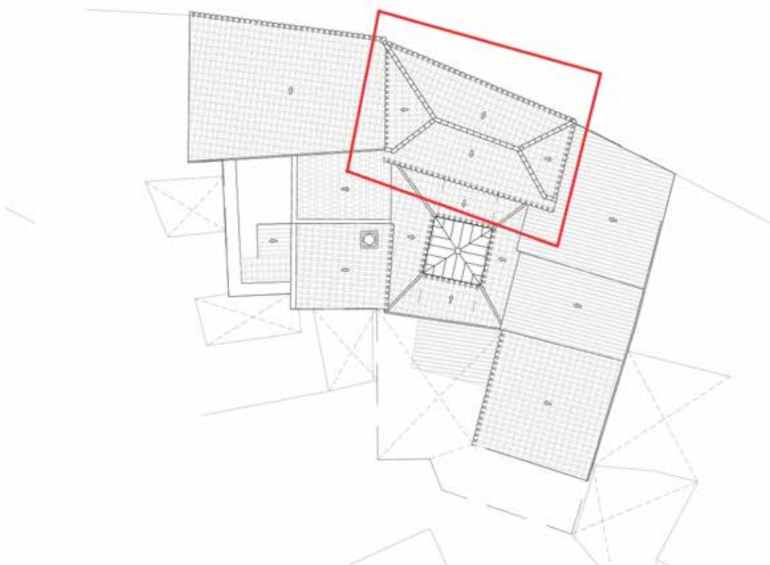
Figura 3. Planta de cubiertas en el estado previo. Señalada en color rojo se indica la cubierta del mirador, bajo la que se ha descubierto una de las armaduras inéditas del edificio, en este caso de pares y nudillos con tirantes simples y cuadradas en las esquinas.
