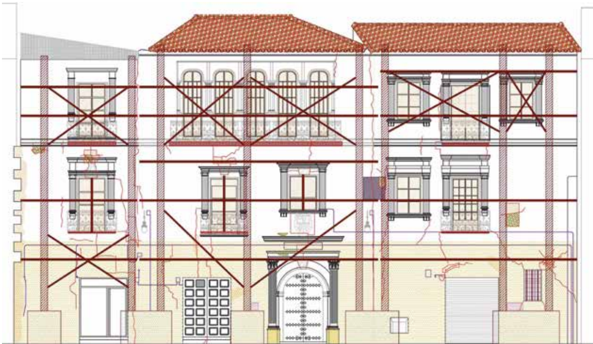
Figura 2. Arriba, Ortoplano fotográfico vectorizado realizado en 2008. Debajo. Plano de patologías de la fachada principal en 2015.
