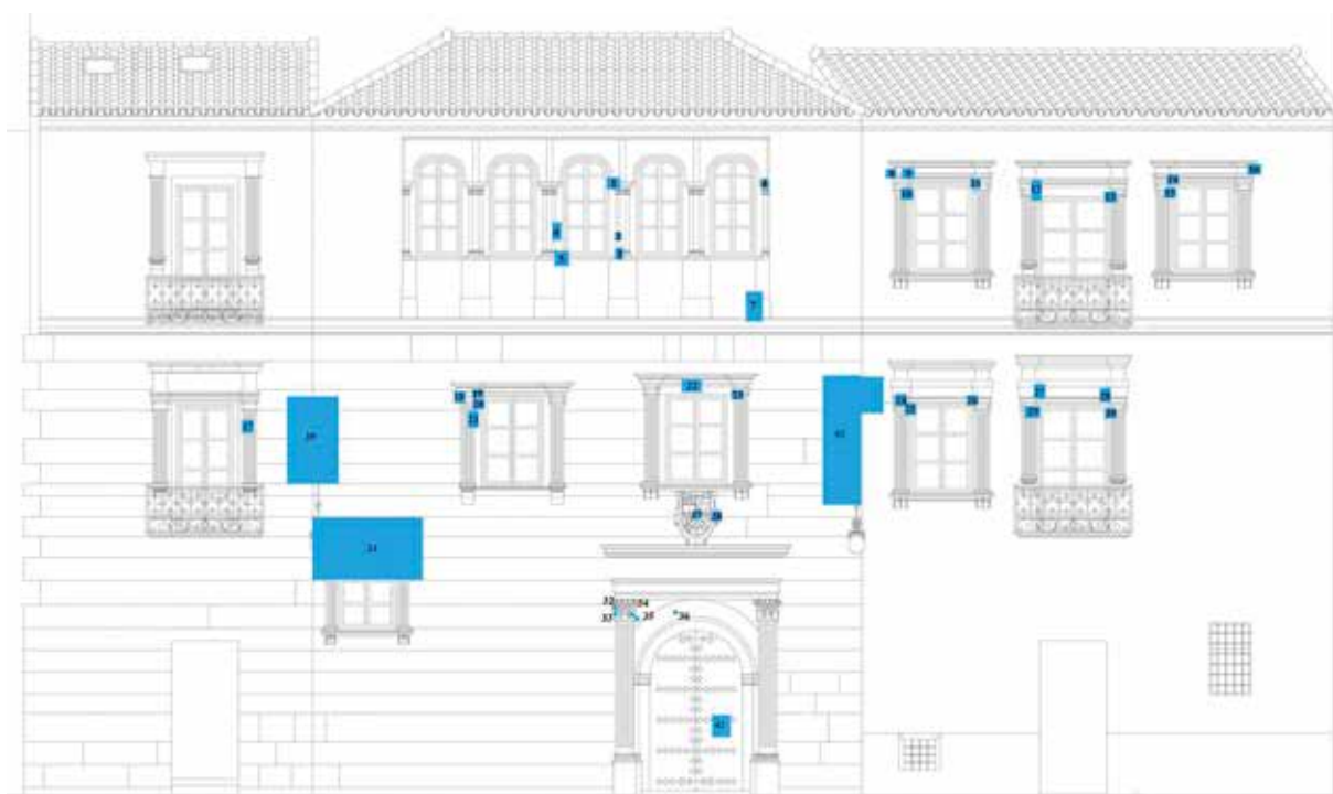
Figura 5. Arriba: Alzado principal con localización de las catas efectuadas. Debajo: Fotografías de la ficha correspondiente a la cata marcada con un punto rojo, en la que se aprecia una capa exterior de pintura plástica beige con base blanca y por debajo, un temple de color almagra aplicado sobre una fábrica de ladrillo (se repite a lo largo de todo el fuste).
