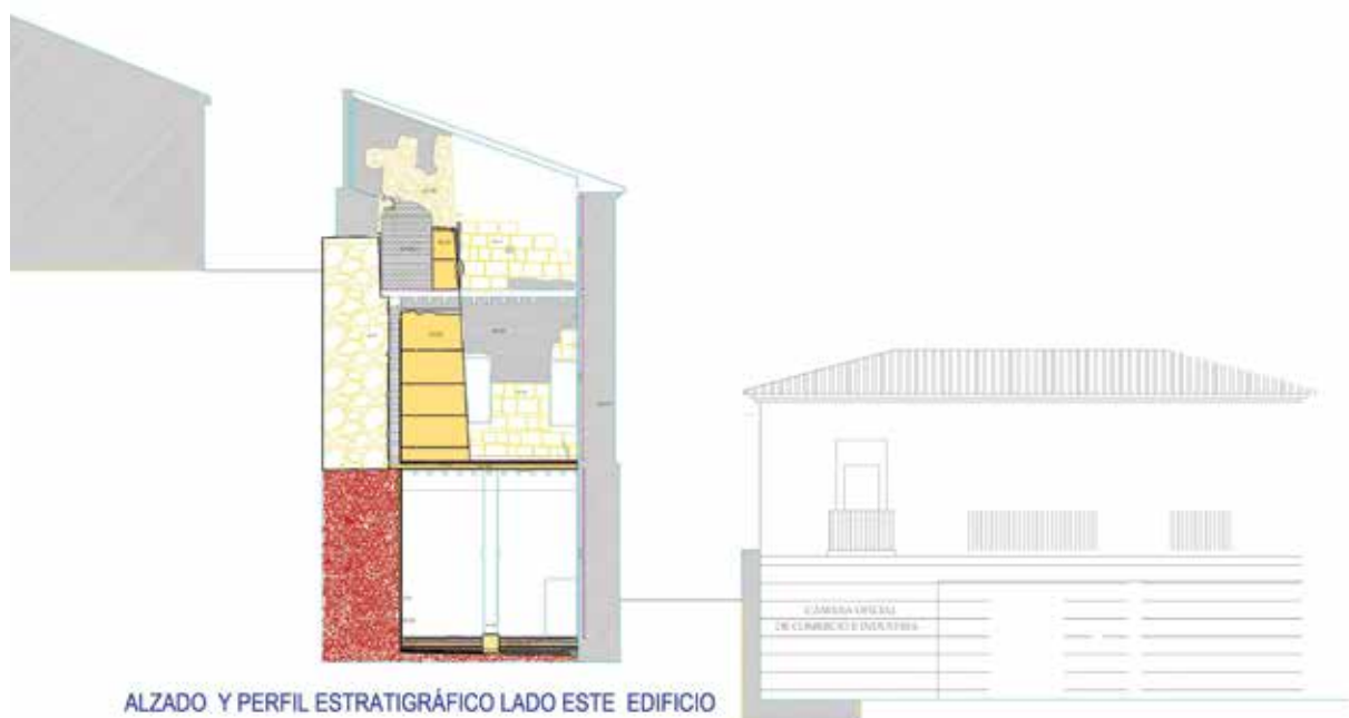
Figura 3. Sección del Pósito donde se aprecia el alzado de tapial conservado de la cara occidental de la torre del Reloj.
