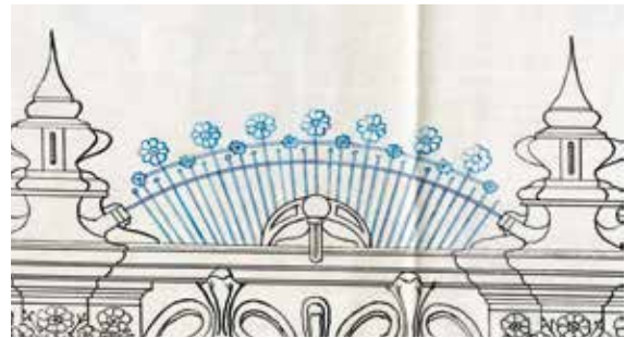
Lámina 4. Elementos ornamentales de la rejería de la planta baja similares al remate no ejecutado.
