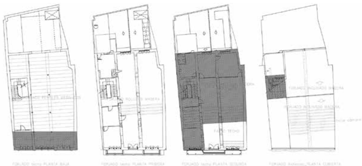
Figura 3. Plantas estado original sistema estructural.
