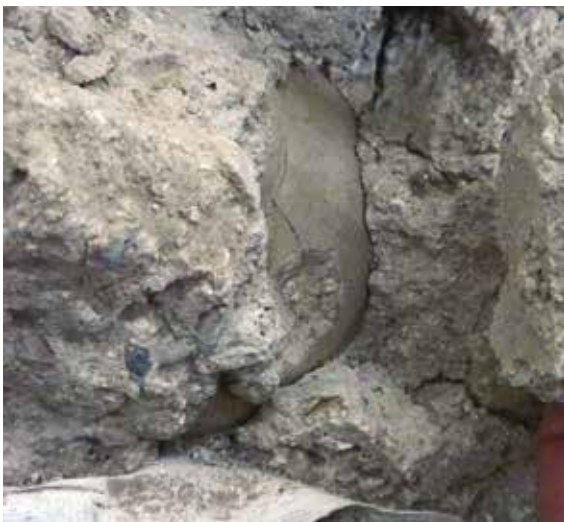
Lámina 7. Impronta de la rotura de la cerámica en el mortero.
