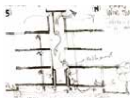
Figura 16. Esquema del aprovechamiento de las masas de aire y hacerlo circular sin la utilización de aparatos mecánicos. (Fuente: autor del artículo).
