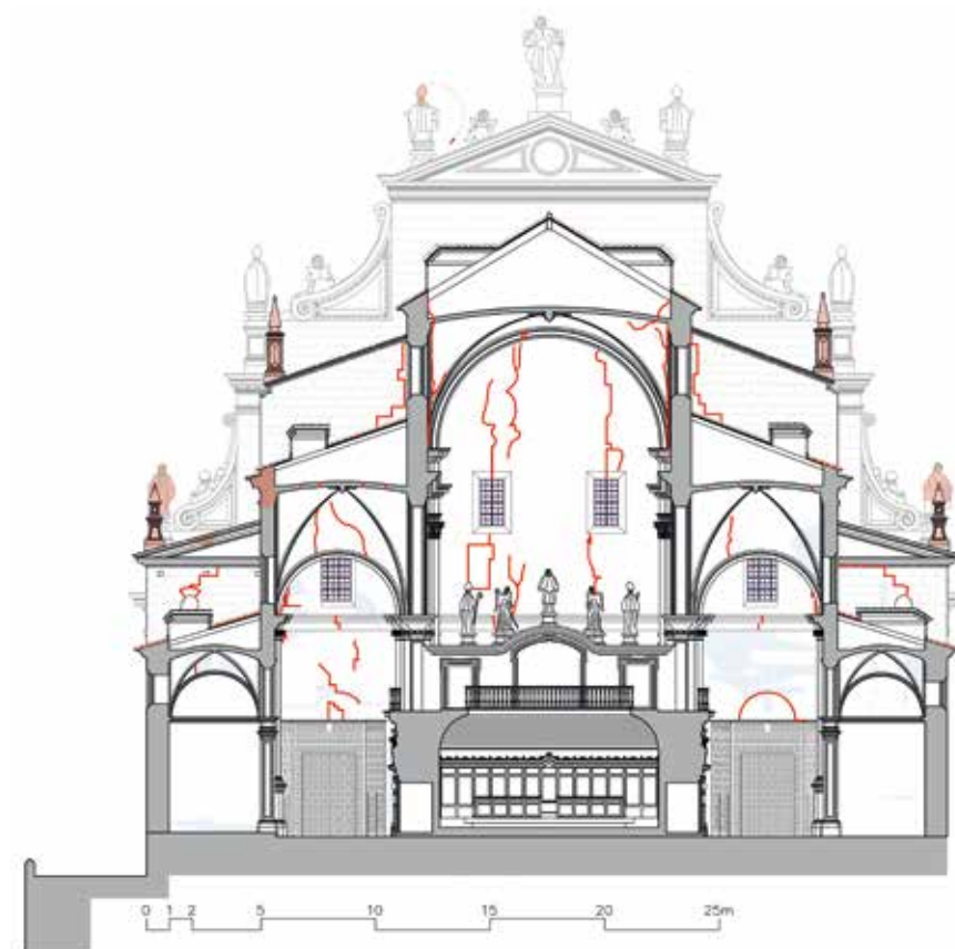
Figura 5. Sección transversal de la colegiata de San Patricio, indicando las patologías más importantes detectadas tras los sismos.
